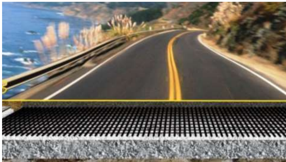
Армирование дорожного полотна геосеткой
