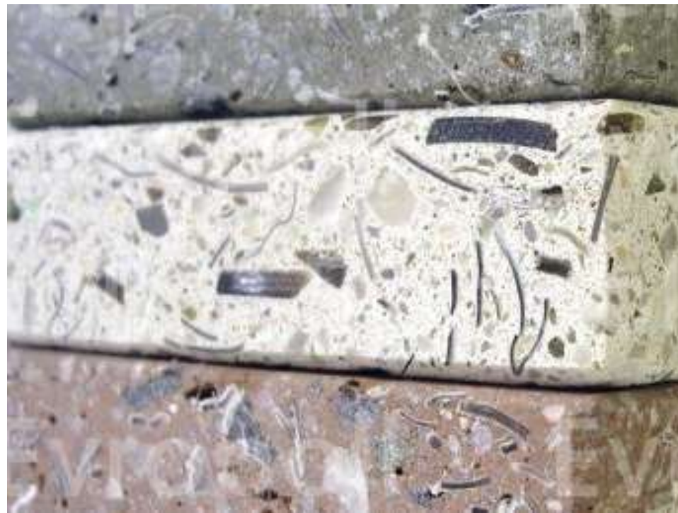
Армирование бетона композитной фиброй (фибробетон)
